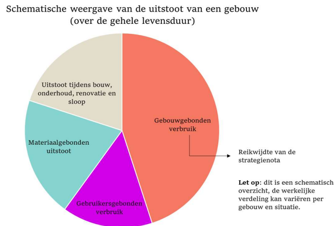
Figuur 3. Illustratie van de uitstoot van een gebouw over de gehele levensduur
